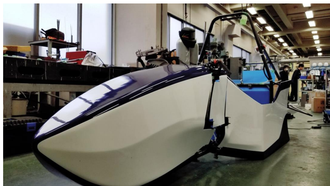
(上) 完成したカウルをフレームに合わせる様子
